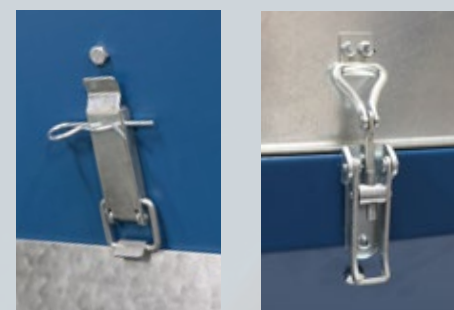
Système simple pour fixer la trémie amovible au mangeoire et l'extension à la trémie
